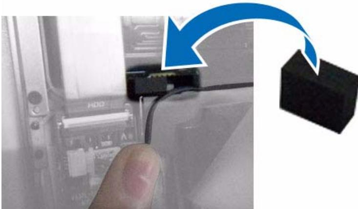
6 Montieren Sie das Kabel nach Einsetzen des Gummiblocks wieder.
