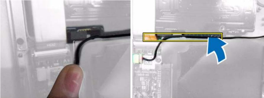
7 Befestigen Sie das Doppelklebeband über dem Kabel und dem Gummiblock, um sicherzustellen, dass das Kabel fixiert ist.
